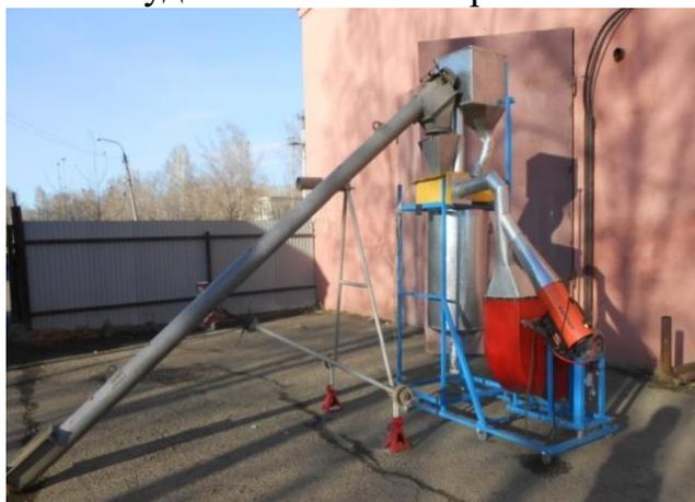
Рисунок 2 – Малогабаритная вихревая сушилка
