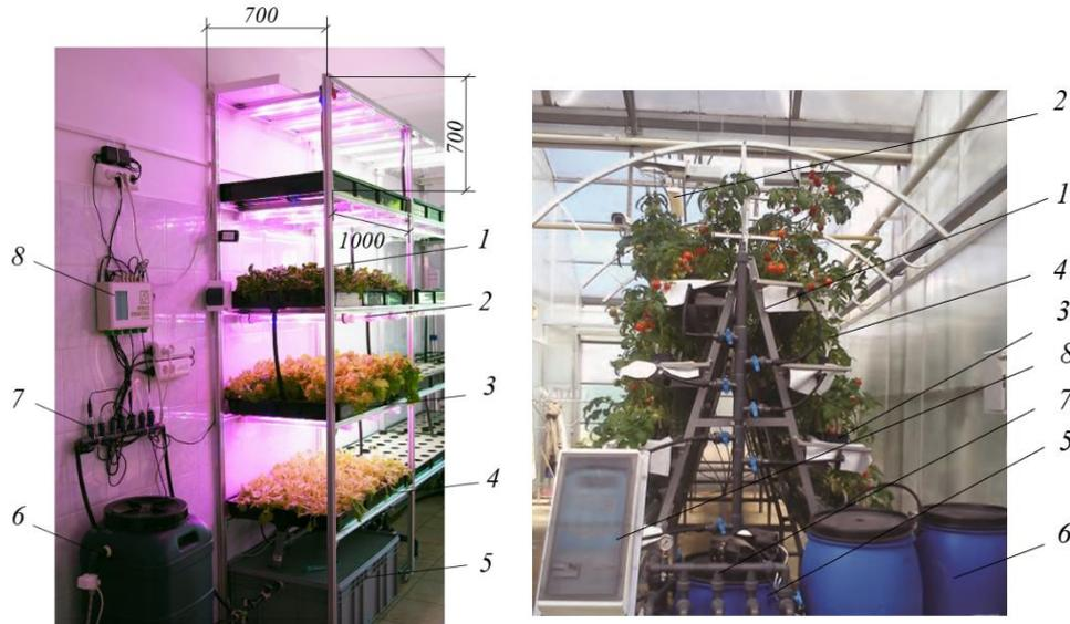
Рисунок 1 – Гидропонная установка с оборудованием: а) стеллажного типа; б) узкостеллажная. 1 – стеллажи; 2 – светодиодные облучатели; 3 – рассадные кассеты с горшками; 4 – выращиваемая культура; 5 – смесительная емкость; 6 – емкость с питательным раствором; 7 – растворный узел; 8 – пульт управления
